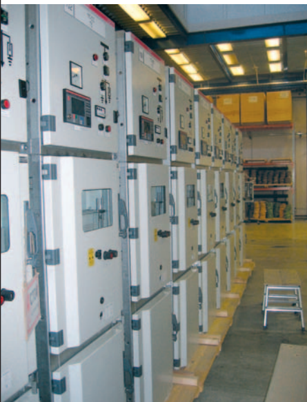
КРУ серии UniGear ZS1, готовые к отправке заказчикам
